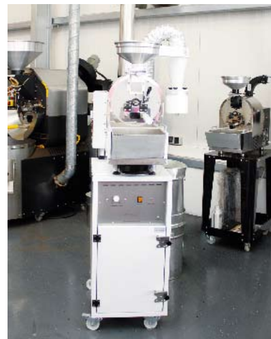
Die drei Coffee-tec-Röstmaschinen Ghibli R15 (15 kg), Solar (2 kg) und Torrefattore (2 kg) stehen im hinteren Teil der Rösterei. Den kleinen Torrefattore hat Bonafede mit einem Abluftfilter versehen. Er benötigt daher keine Abluftrohre und kann frei im Raum bewegt werden. (Bilder von li. nach re.)
